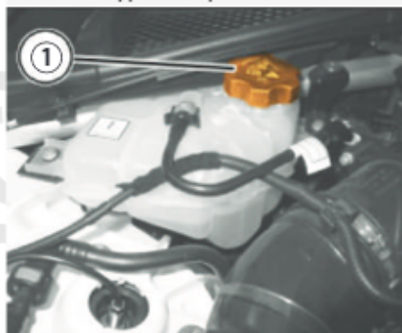
Rimozione tappo vaso espansione
